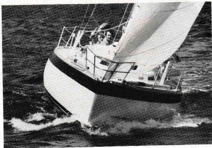
Cette photo met en valeur le frégatage marqué et l'importance du maître bau.
