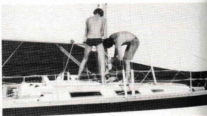
La prise de ris dans la grand'voile s'effectue à partir du pied de mât, seules les manœuvres de spi reviennent au cockpit.
