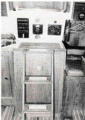
Au-dessus de la descente, le tableau de commande électrique et le tableau de bord du moteur avec des inscriptions en anglais. A droite, le coin navigation.
