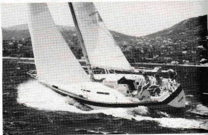
Avec le Genois 2 et un ris dans la grand'voile, le bateau au près étale facilement un mistral de 25 nœuds à l'anémomètre.
