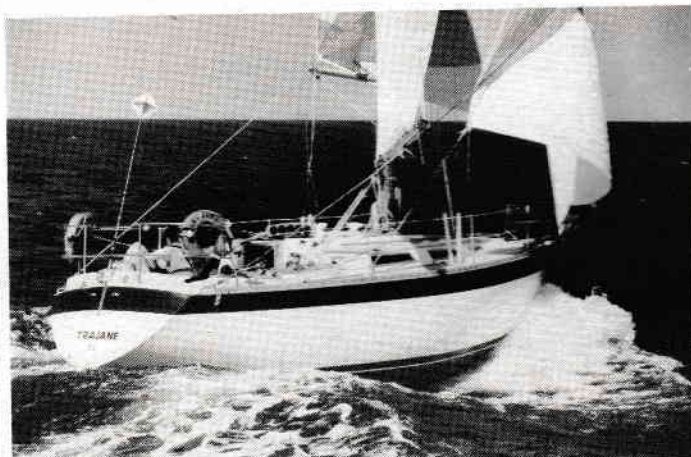
A sa vitesse maximum, la carène provoque un creux important entre ses vagues avant et arrière, montrant son déplacement assez lourd.
