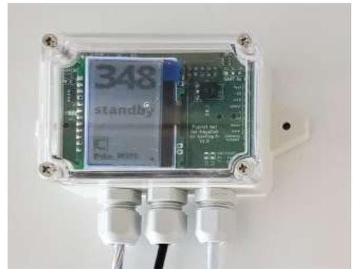
Le boîtier du calculateur, complètement étanche, comprend un circuit imprimé intégrant l'afficheur LCD, l'IMU, l'interface UART vers le contrôleur moteur, un port NMEA0183 avec entrée isolée galvaniquement, des protections CEM contre les surtensions et un connecteur GPIO permettant d'utiliser un Raspberry Pi Zero 2W ou Zero W. Le circuit imprimé est marinisé côté composants par application de trois couches de vernis tropicalisant. Il dispose de bornes pour y connecter un clavier à 8 boutons.
