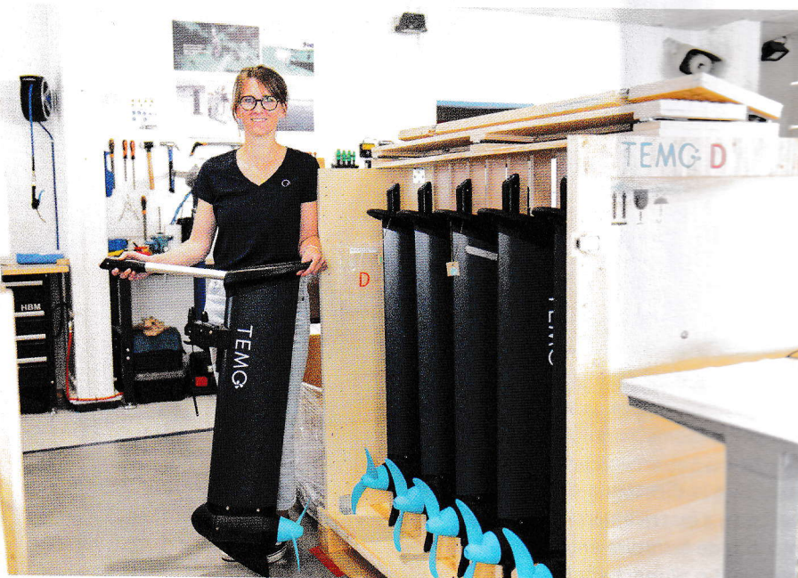
Justine Perussel, co-fondatrice de Temo présente un moteur électrique à bateau, de 1000 watts. © Roselyne Belz
