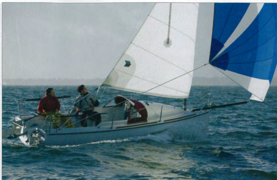
▲ Sous spi, l'lkone J doit s'incliner devant le sloop en raison de son mât tournant non haubané. Notez, au niveau de la grand-voile, la latte verticale qui tient sa chute.
