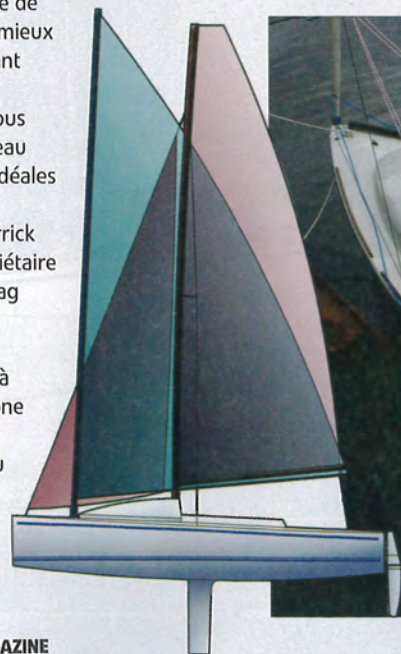
Le mât de l'lkone J ne comporte aucun haubanage et son cockpit est dépouillé.
