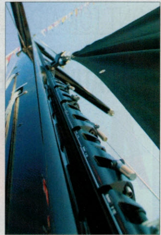
FACNOR Le spécialiste des enrouleurs décline ses « Facslide » en deux versions, standard (billes Delrin) et renforcée (billes Torlon).
