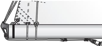
*Afin de faciliter l'utilisation d'une retenue de bôme, une estrope peut être installée de façon permanente entre l'embout de la bôme et le coulisseau de hale-bas. Fixer l'estrope sur l'embout de bôme, faire un œil épissé à l'autre extrémité sur lequel sera fixé un sandow. Au repos, le mou de l'estrope sera repris en tendant le sandow.*
