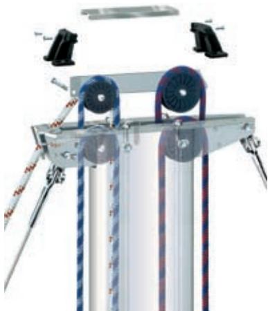
*Enlever les supports instruments et l'entretoise des réas. Soulever les réas pour vérification. Remplacer les réas si nécessaire, et replacer l'entretoise.*
