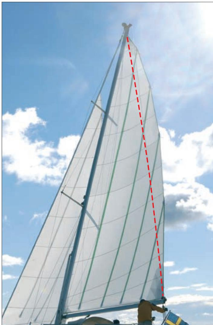
Ceux qui pensaient qu'une voile sur enrouleur était moins performante à cause d'un rond de chute insuffisant avaient tort. Les nouveaux mâts enrouleurs Seldén sont conçus pour accepter des lattes verticales et un véritable rond de chute positif.
