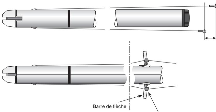
Embouts à fixer au niveau des ancrages des barres de flèche, sur les haubans tendus le long du mât. L'angle vertical final des barres de flèche doit toujours être de 6°.
