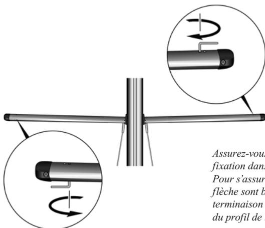
*Assurez-vous de bien serrer les boulons de fixation dans le sens des aiguilles d'une montre. Pour s'assurer que les embouts de barres de flèche sont bien fixés, il faut vérifier que la terminaison des boulons ne dépasse pas le trou du profil de la barre de flèche.*
