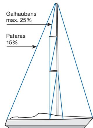
Ce type de gréement est très exigeant car il est très complexe à régler et à utiliser. En général, ce type de gréement requiert plus de tension dans les haubans qu'un gréement avec des barres de flèche non poussantes.
