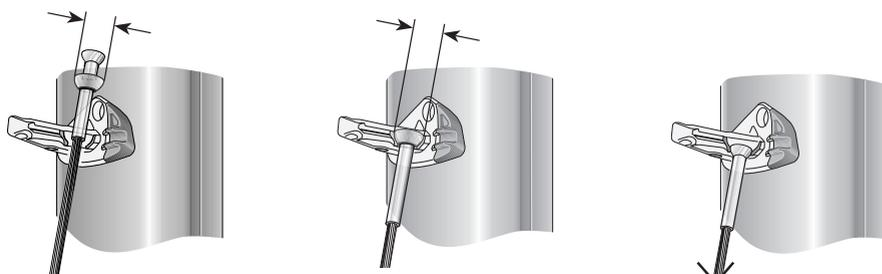
coupelles. L'utilisation d'une ou deux de ces coupelles permet une adaptation correcte à la dimension du logement. Mesurer la largeur de l'ensemble complet, y compris les coupelles pour s'assurer que toutes les coupelles sont correctement positionnées.
