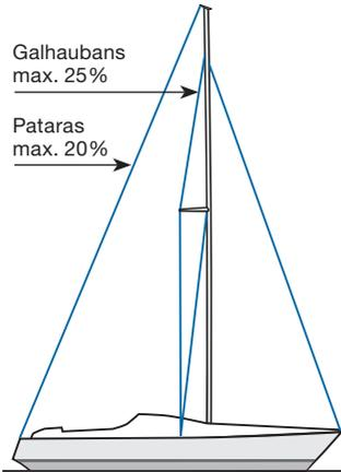
En général, ce type de gréement nécessite plus de tension dans les haubans qu'un gréement avec barres de flèche non poussantes. La tension de l'étai est affectée par trois éléments :
