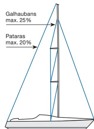
Ce type de gréement est très exigeant car il est très complexe à régler et à utiliser. En général, ce type de gréement requiert plus de tension dans les haubans qu'un gréement avec des barres de flèche non poussantes. La tension de l'étai est affectée par trois éléments :
