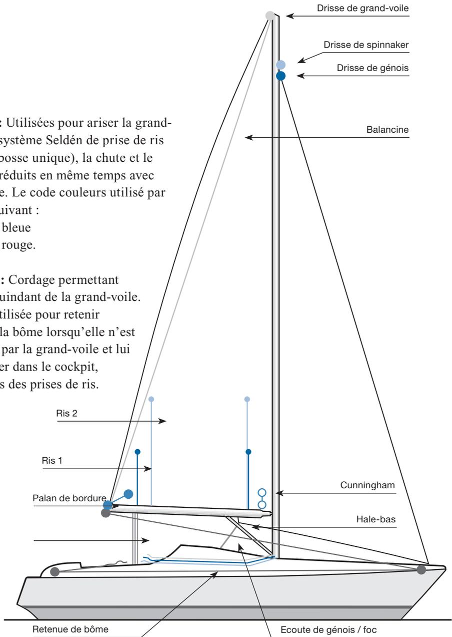
**Bosses de ris :** Utilisées pour ariser la grand-voile. Avec le système Seldén de prise de ris automatique (bosse unique), la chute et le guindant sont réduits en même temps avec la bosse unique. Le code couleurs utilisé par Seldén est le suivant :
