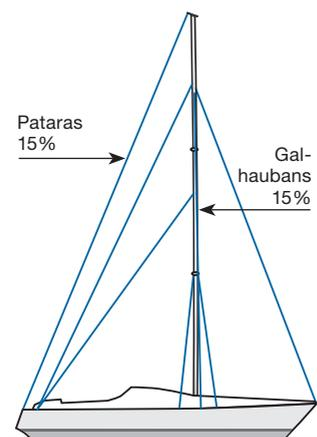
Des bastaques sont nécessaires pour obtenir une stabilité longitudinale suffisante et obtenir la tension voulue sur l'étai. Les patares doivent être fixés aussi près que possible de l'axe longitudinal de la coque, de façon à ne pas affecter le réglage latéral. Ce type de gréement se rencontre aussi avec bas haubans simples, dans ce cas des basses bastaques sont recommandées pour contrôler un cintrage excessif du mât.
