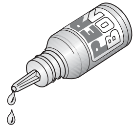
Colle de blocage.
