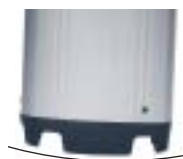
Emplanture convexe sous le pied de mât répartit la compression sur la section du mât.
