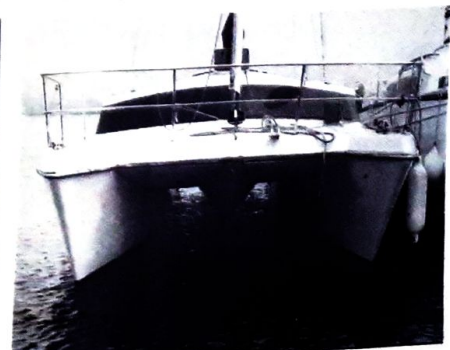
Le carénage central du Quest : pratique pour la motorisation, mais cause d'une traînée importante.
