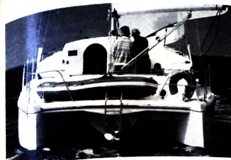
Coques volumineuses et efficacité moyenne des safrans profilés sur le Snowgoose.
