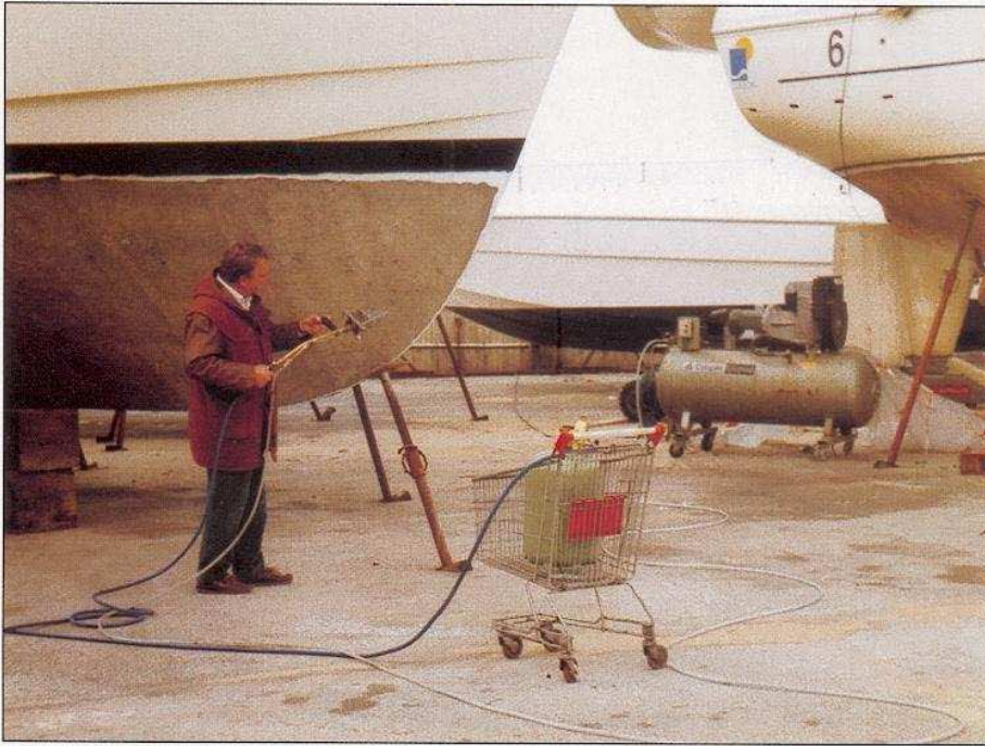
Photo 2-18 : chalumeau à air comprimé "HYAB"
