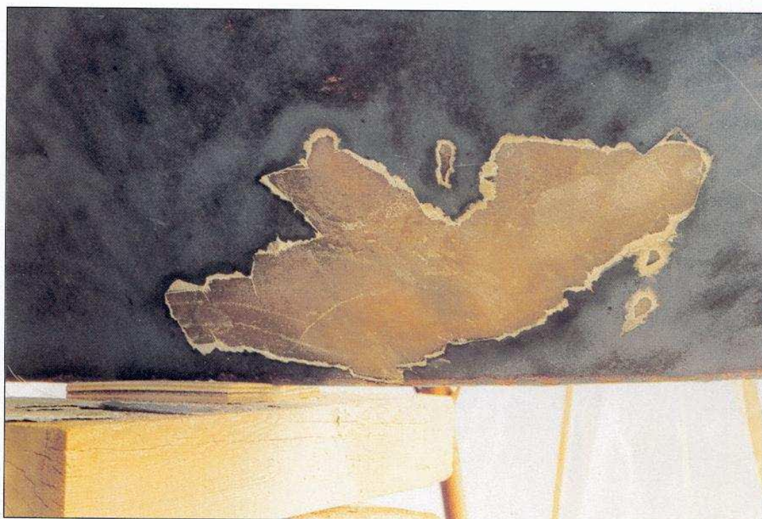
Photo 2-39 : la couche dure se détache facilement du pli suivant
