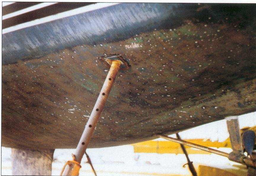
Photo 1-3 : un ponçage léger fait apparaître la densité des cloques
