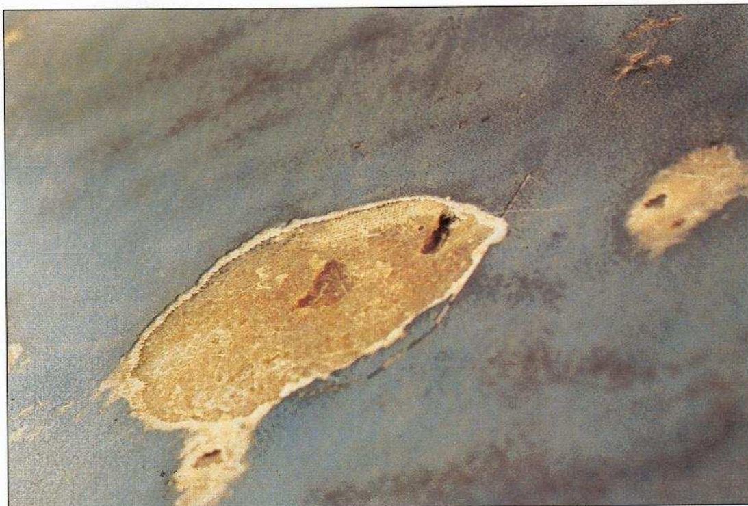
Photo 2-40 : la couche dure est constituée d'un mat et d'un tissu léger
