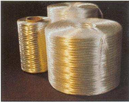
Photo 2-52 : bobine de roving ou "Stratifil" - phot. VETROTEX
