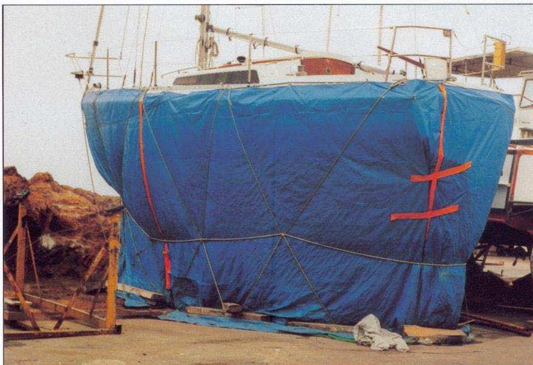
Photo 2-8 : tente pour accélération du séchage par chauffage
