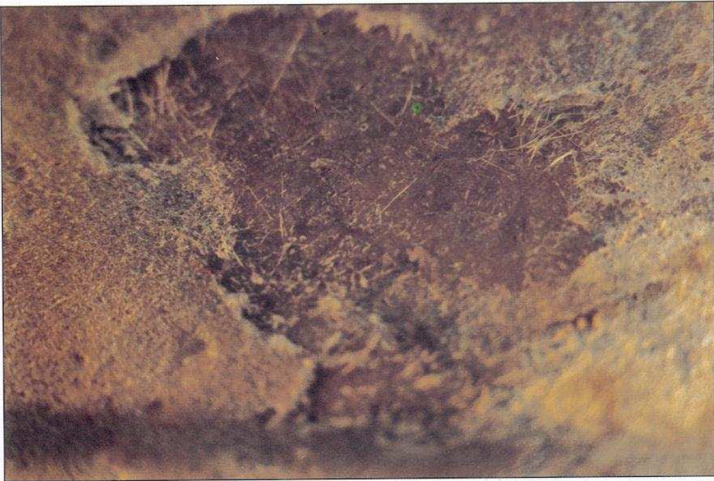
Photo 2-28 : dégradation du gelcoat (au-dessus de la flottaison) activée par l'eau chaude de l'échappement
