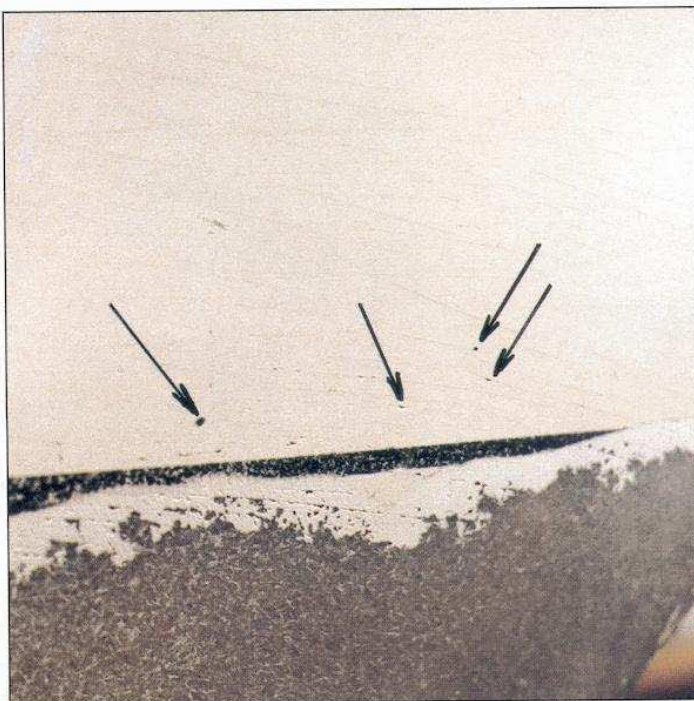
Photo 2-27 : éclats et fendillements d'un gelcoat pas assez souple
