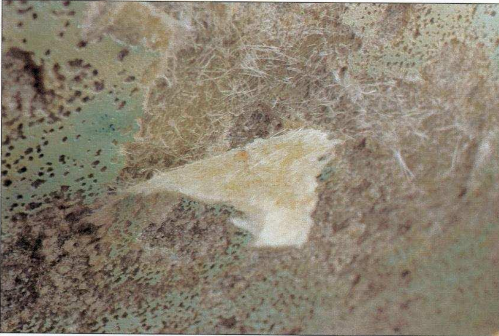
Photo 2-34 : les premiers mats s'arrachent facilement. L'interface avec les plis suivants est pauvre en résine
