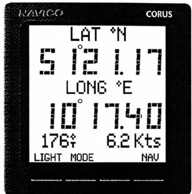
Fig 2.4 - Cadran Datacentre C700DC
