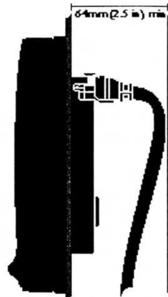
Fig 5.1 - Espace minimum au dos du cadran
