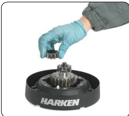
10. Remove the gear n°15
