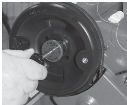
Embrayage Posi-Pin désengagé.
