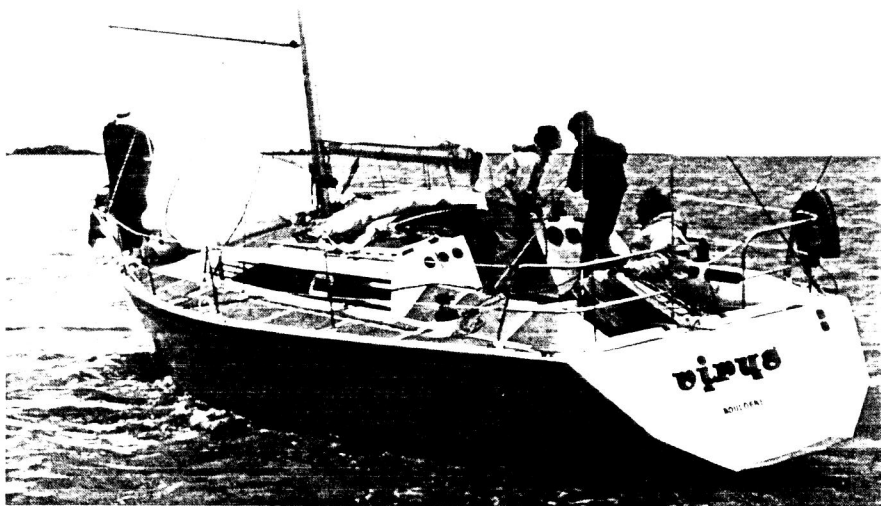
Un équipier sur l'avant suffit à dégager complètement la jupe de l'eau.
