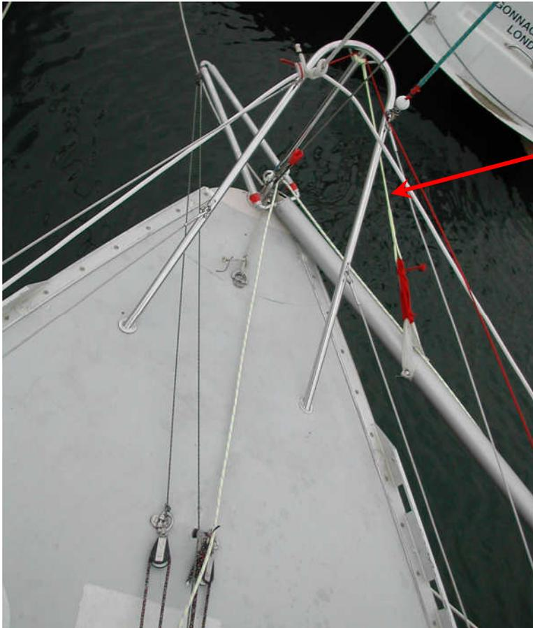
1 Estrope balcon avant Pogo 2
