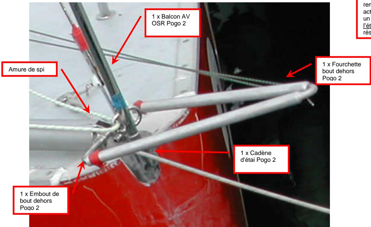
**Vous trouverez quelques photos, ci-jointe, d'un kit installé sur un Pogo 2 :**
