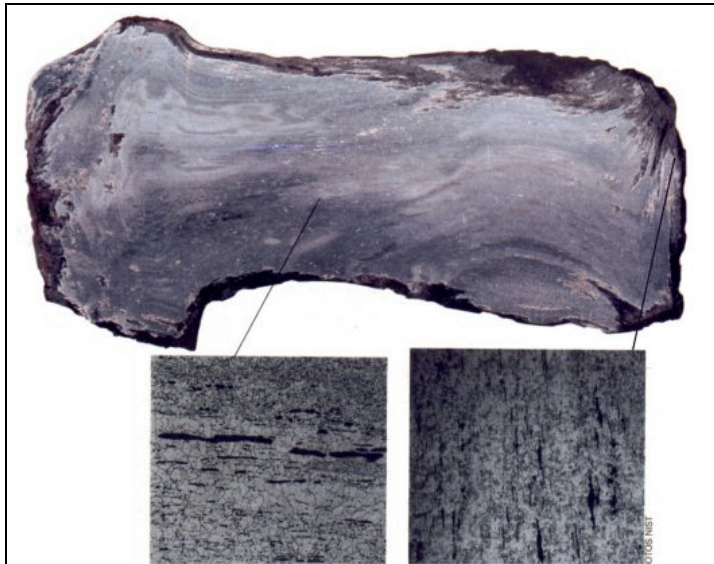
Figure 3 Le microscope révèle les failles Sciée dans sa longueur, ce rivet révèle que le fil des inclusions court selon son axe (à gauche). Au bout du rivet (à droite), le fil tourne brutalement à angle droit ; cette pliure des fibres crée une zone de très grande fragilité.
