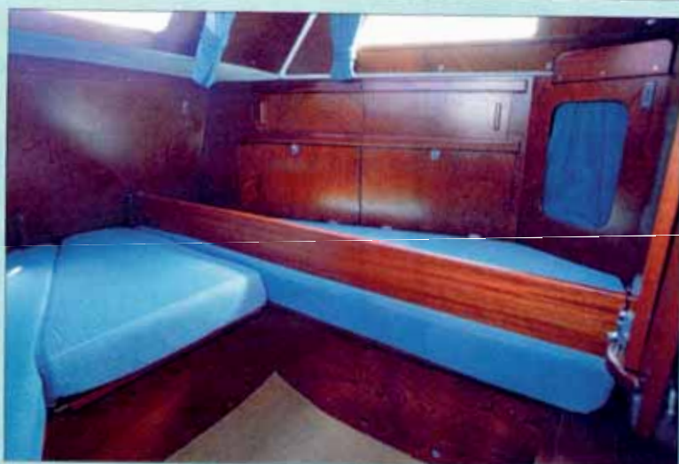
Les couchettes de la cabine arrière ont des planches antiroulis.
