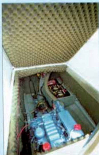
Le moteur Perkins de 40 ch sorti en 96 n'a que 3 800 heures de marche.
