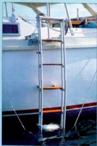
Pas de jupe sur le Sharki mais une échelle qui pivote et se remonte le long des filières.
