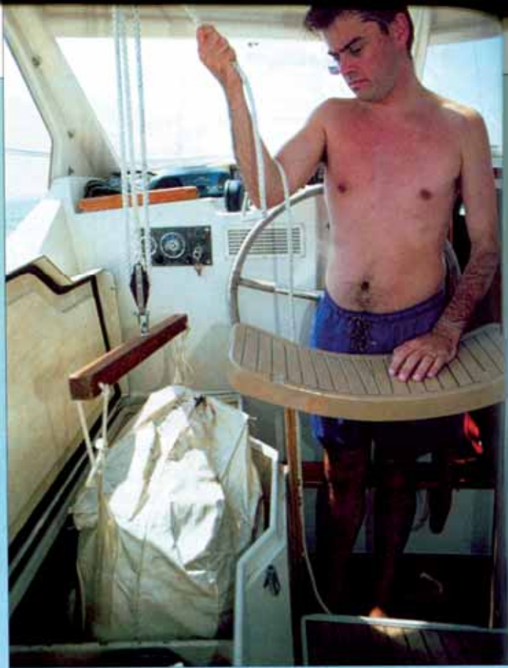
Dans le cockpit, un palan permet de sortir la survie du coffre.
