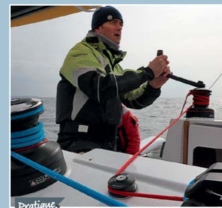
Pratique Les renvois à plat-pont sont bien utiles quand l'un des winches est pris par l'écoute de génois.
