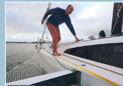
Pratique La main courante (garnie de cuir) est indispensable pour passer de l'appui du balcon à celui du hauban.
