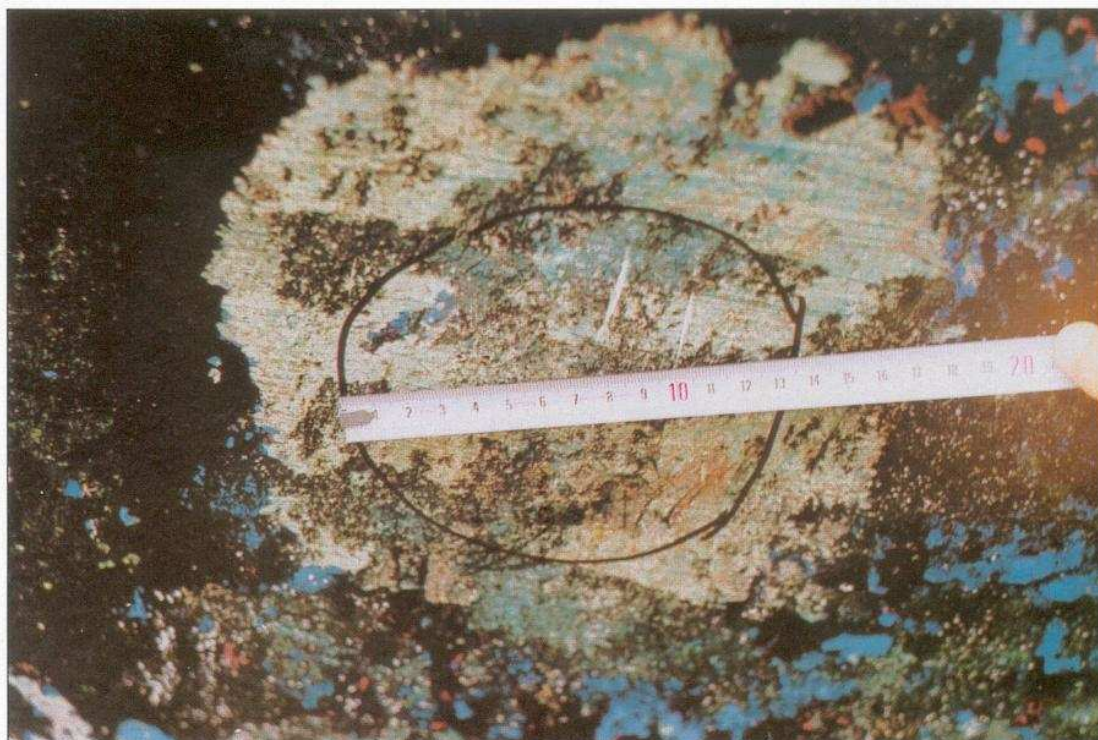
Photo 2-42 : très grosse cloque (Ø 13 cm - flèche 5 mm) sous le 3ème mat
