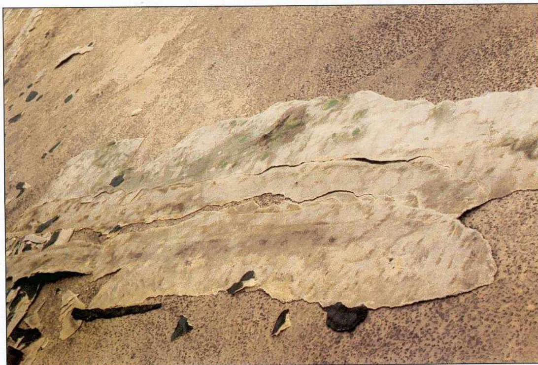
Photo 2-41 : cette couche dure a été "pelée" par bandes de 2-3m de long
