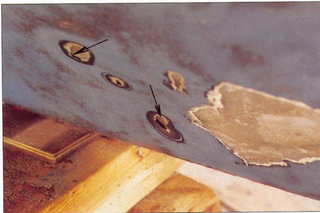
Photo 2-37 : dans le trou on voit le vide entre la couche dure et le pli suivant
