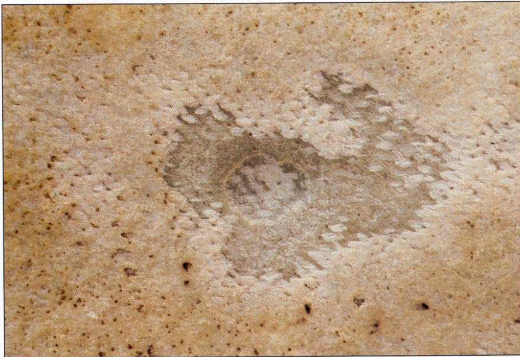
Photo 2-32 : dégradation des premiers mats, du roving suivant, des mats suivants et enfin du 2ème roving. Profondeur du cratère : 9 mm
