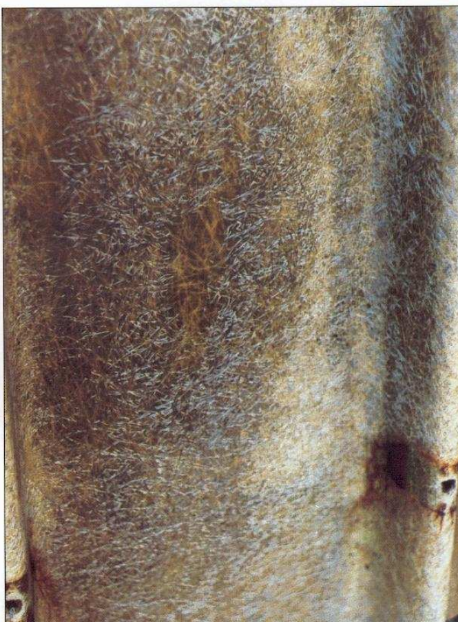
Photo 2-21 : partie marron centrale : il y a encore de la résine
