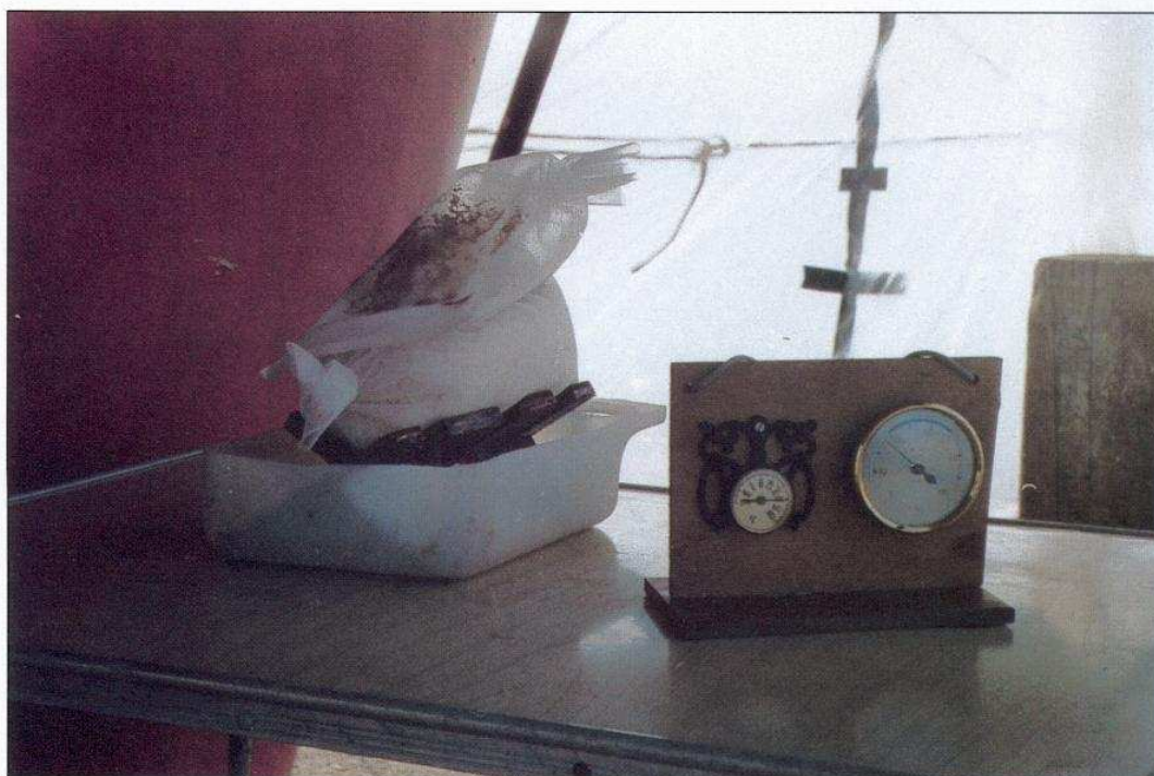
Photo 2-11 : mini station météo et absorbeur "Rubson"
