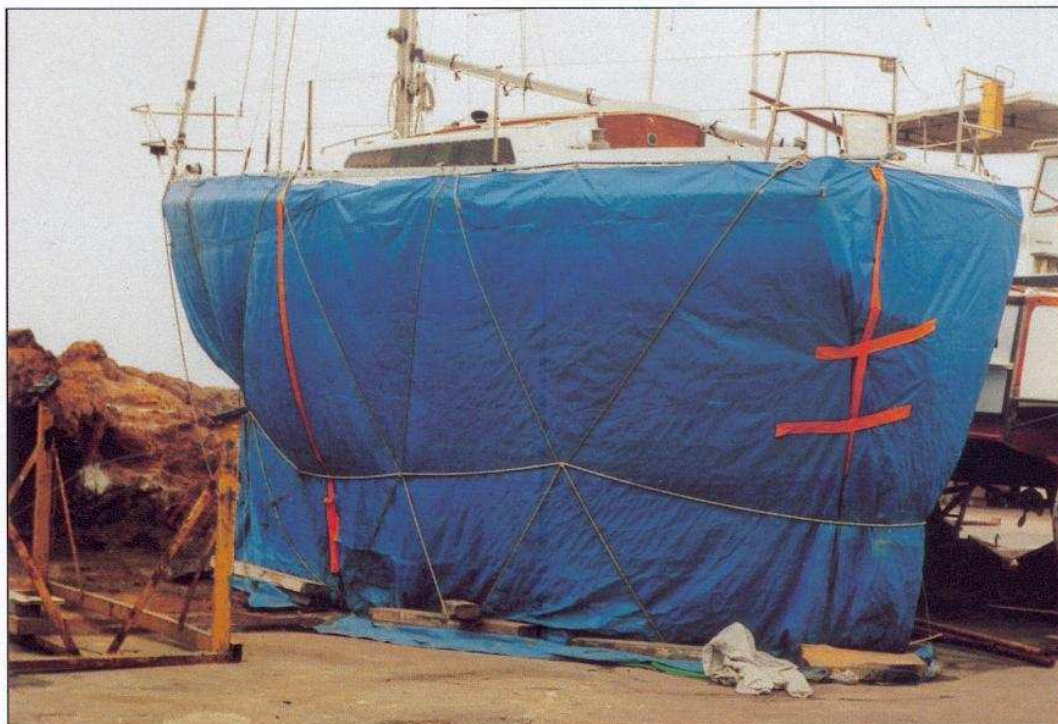
Photo 2-8 : tente pour accélération du séchage par chauffage
