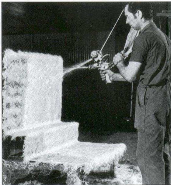
Photo 2-54 : projection simultanée phot. VETROTEX
