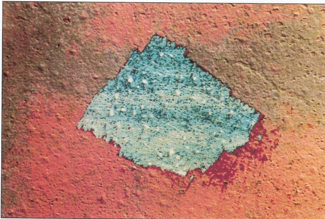
Photo 2-23 : il faut gratter l'anti-fouling pour que les petites bulles blanches apparaissent
