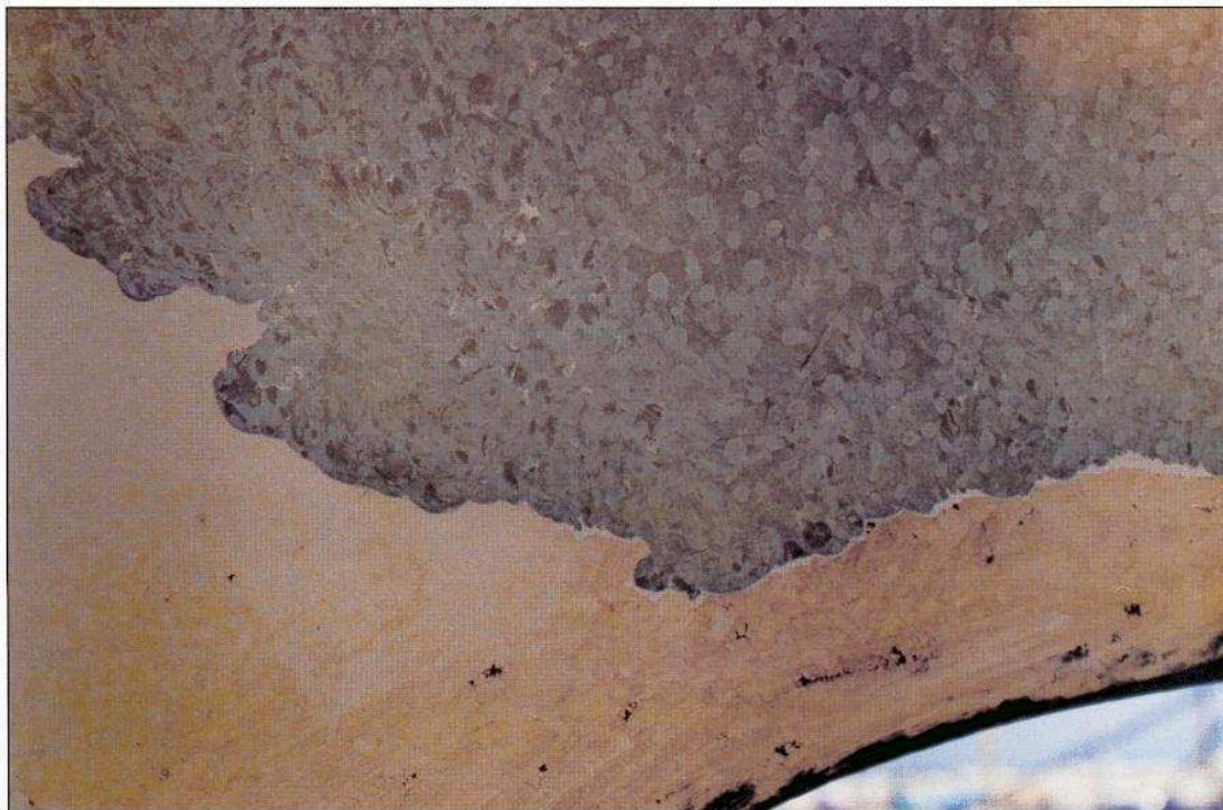
Photo 2-49 : délai trop long entre gelcoatage et stratification. Pas d'attache entre gelcoat et résine du stratifié. Le gelcoat se pèle facilement
