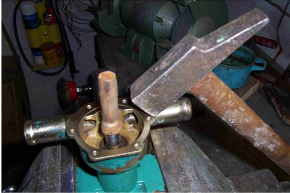
A l'aide d'un crochet, extraire les deux joints spi
