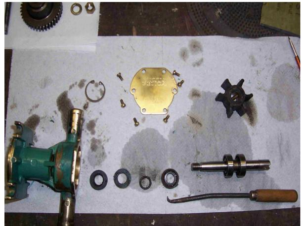
Bien repérer le sens de montage des joints spi, entre les deux se trouve une rondelle entretoise et un joint torique.
