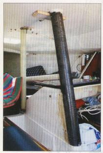
Le tube carbone destiné à renforcer le puits de dérive suite au changement de type de quille.
