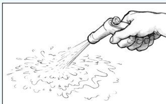
Figure 33 Rincer la surface avec de l'eau fraîche après ponçage.
