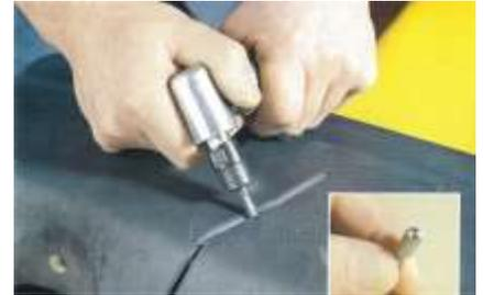
*Le meilleur moyen de réaliser le chanfrein en « V » à 90° consiste à utiliser une fraise frontale de Ø5,5 mm*
