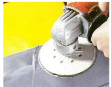
*L'arasage de la soudure devra être fait aux disques n° 120 puis 180 et pour finir 320 afin d'obtenir un beau fini. On peut aller encore plus loin si on le veut jusqu'au poli parfait avec du papier abrasif encore plus fin. Préparer ainsi une bande d'environ 10 cm de chaque côté de la soudure.*
