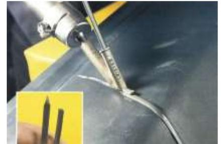
*Les baguettes d'apport doivent être biseautées pour permettre un remplissage progressif et complet du début de chanfrein. La technique de soudage des plastiques est plus facile à apprendre que celle du soudage des métaux traditionnels. La base de la buse rapide est parallèle à la surface de la pièce et la pression doit s'exercer **seulement sur la baguette**, et non pas sur le chalumeau et la buse.*
