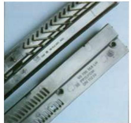
*La plupart des fabricants automobiles marquent sur les pièces en plastique le code d'identification de celui-ci.*
