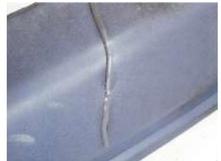
*La baguette après soudage doit dépasser légèrement au-dessus de la surface de la pièce et être lisse.*
