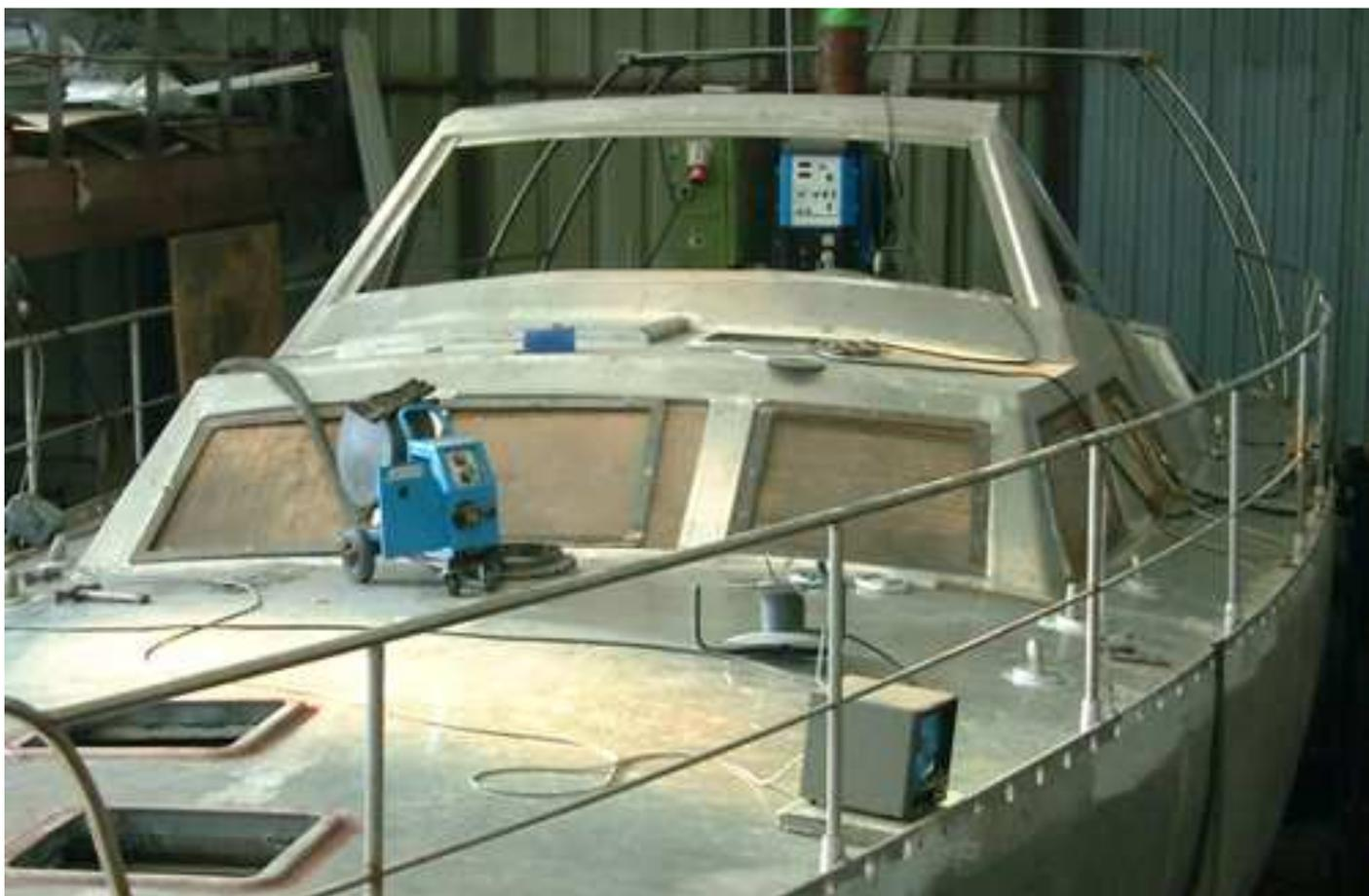
**Chatam 52.** Abri de barre ouvert côté cockpit. En inox. Il est considéré comme un simple abri de la descente et n'est pas pris en compte comme un roof : ni pour son étanchéité, ni pour ses échantillonnages, ni pour les dimensions ou les épaisseurs des vitrages.
