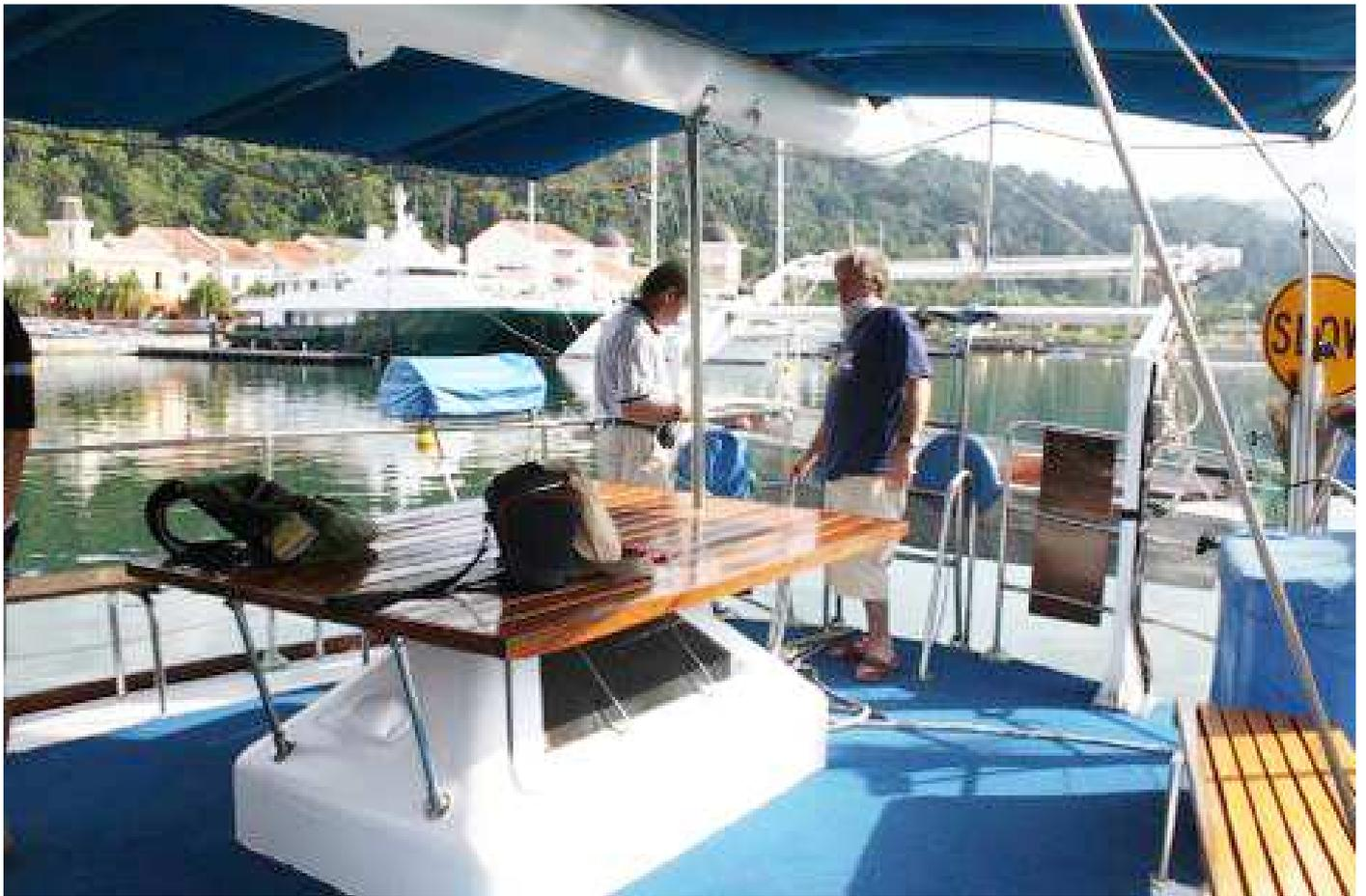
Ce grand bateau, de type mixte voile-moteur, sur plans Bollard, c'est toute la plage arrière qui « sert de cockpit ». Le volume intérieur y gagne, et l'ampleur de la plage arrière aussi. Astucieux et intéressants volumes d'éclairage et aération, que ces « dog-houses », dont celui-ci qui porte la table.
