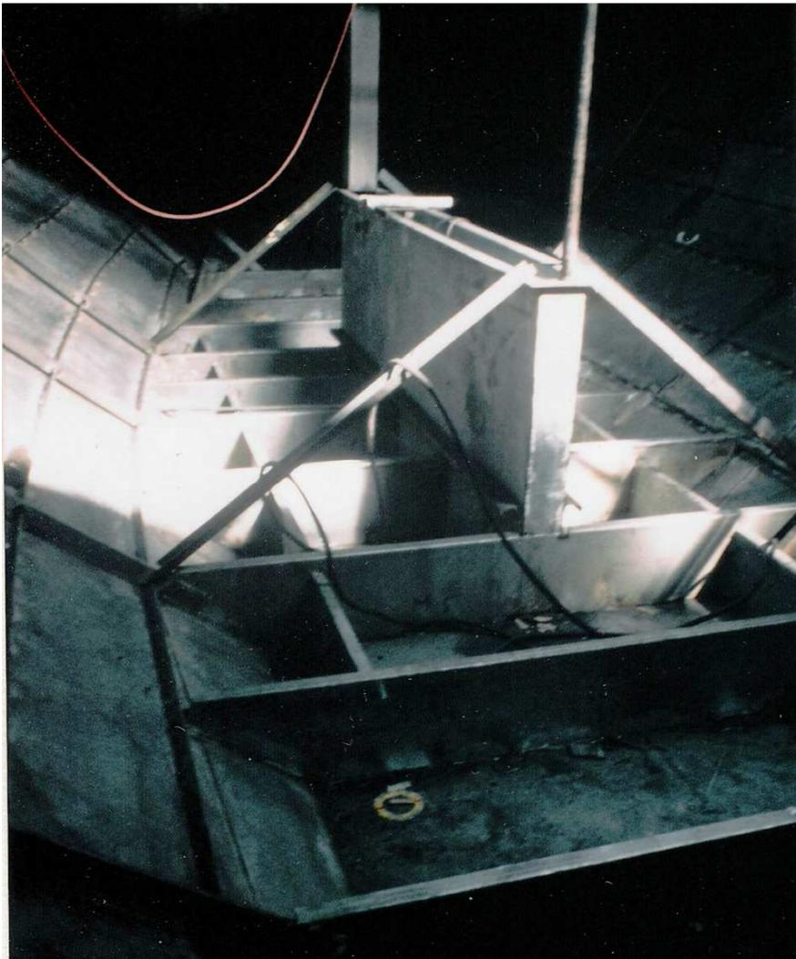
Compartiments tôlés de la caisse à lest d'un dériveur intégral, réalisés en tôles pliées (à percer pour le passage de la plomberie).
