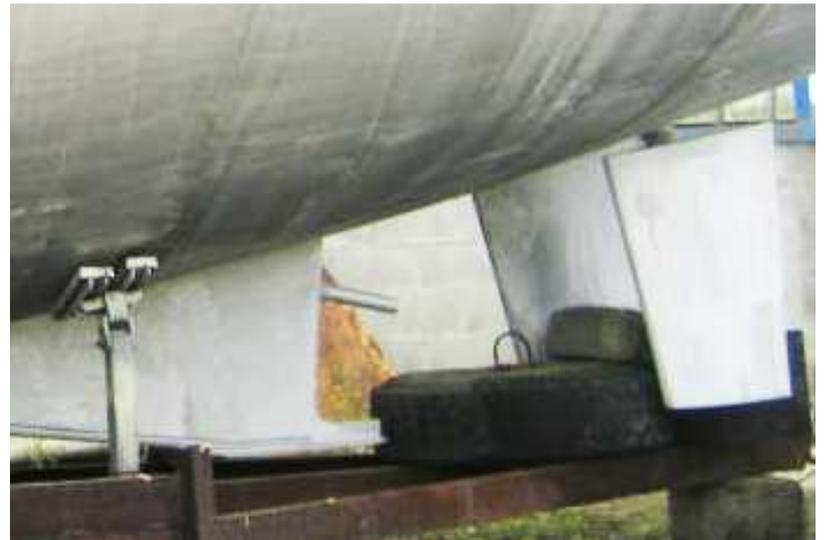
Tube d'étambot et arbre dans l'aileron en construction professionnelle.
