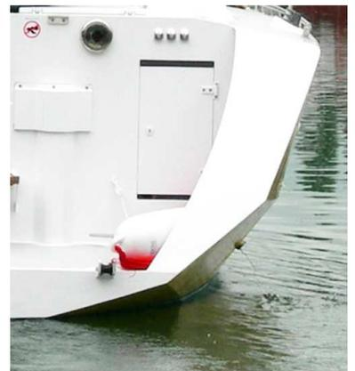
Aération du moteur par boîtes dorade sur le pont ou par aérateurs sur le tableau.
