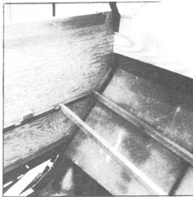
Photo D 63 : Détail de vaigrage (en haut à droite), d'isolation (en bas à droite), de cloison (à gauche) et de tasseaux.
