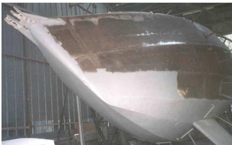
**Sablage** et peinture sont facilités par les vireurs, y compris pour le pont et l'intérieur. C'est pourquoi on ne soude pas les « rayons » des vireurs sur le bateau, mais sur des cornières qui ensèrent coque et pont. On dit en général qu'on doit sabler au stade « SA3 ». C'est quasi impossible pour une pièce aussi grande qu'un bateau. On sable « SA 2½ », en réalité. Mais par prudence on dit SA3...
