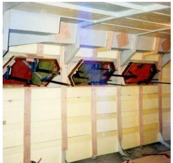
Bateaux à moteur isolés par de la mousse de polystyrène expansé ignifugé. C'est la moins coûteuse. On la trouve dans les grandes surfaces de bricolage sous divers noms de marques.
