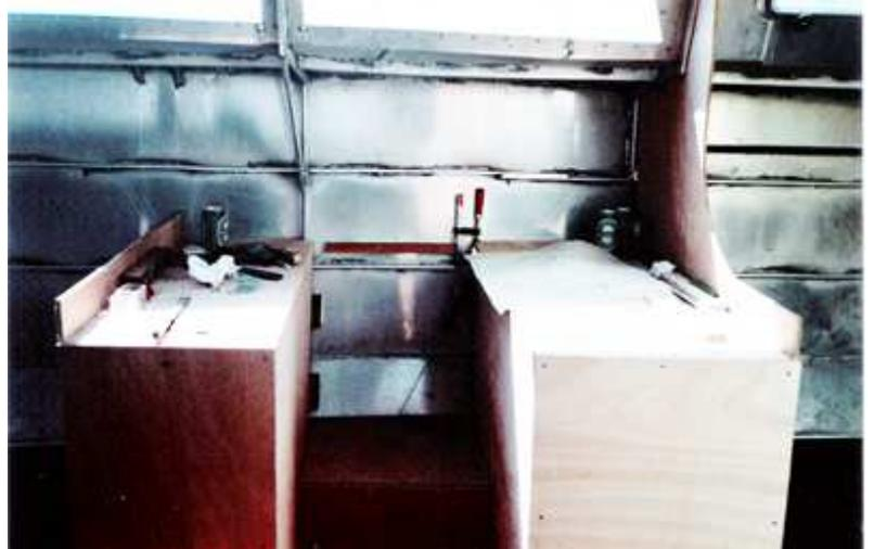
Prépositionnement des cloisons et meubles avant la pose de l'isolation dans ce Chatam en alu.
