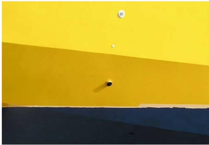
Echappement moteur à plus de 40cm au-dessus de l'eau, bateau en charge.
