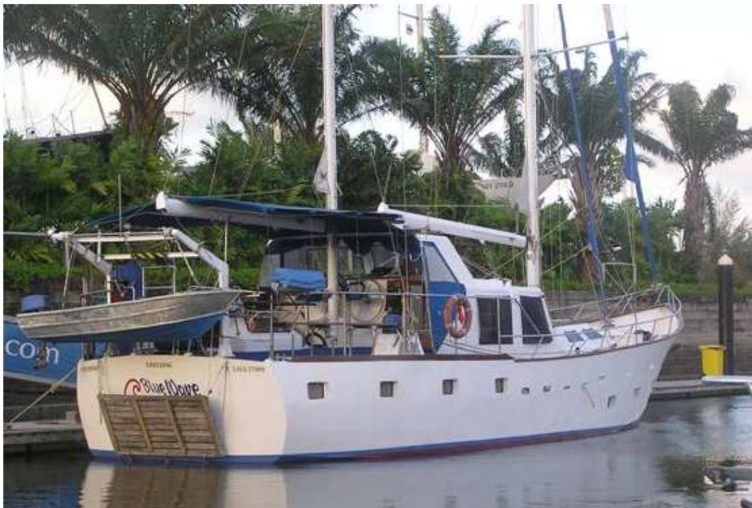
A retenir le bimini-top sous forme d'une bâche sur la bôme. Idée répandue chez tous les navigateurs en eaux chaudes. Souvent on s'arrange pour que cette bâche abrite le cockpit ET le roof ou salon de pont. Double emploi soleil-pluie !
