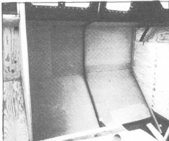
Photo D 65 : Aménagements à leur premier stade. De la mousse est encastrée entre les éléments de structure sur deux épaisseurs.
