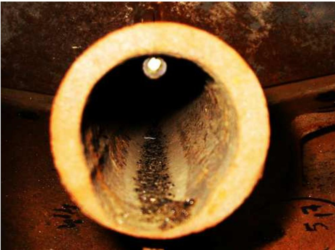
Un moteur mal aligné, ou un arbre trop fin et qui fouette, peut causer des dégâts difficiles à réparer comme cette sortie de tube d'étambot ovalisée (vers le bas de la photo), et peut conduire à une entrée d'eau, voire au naufrage...
