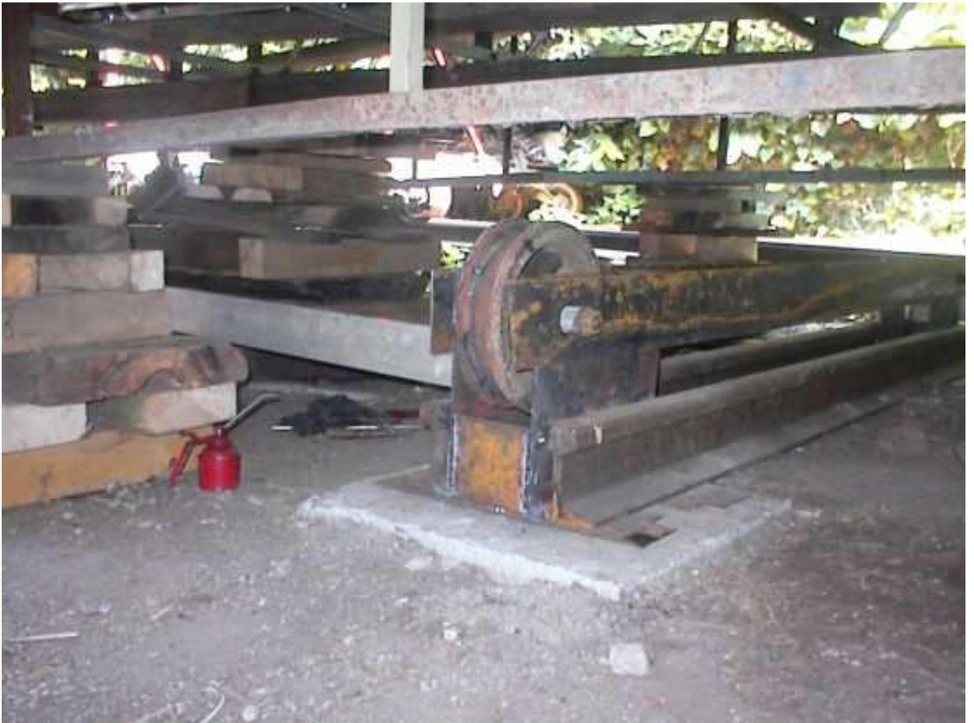
**Fabrication maison d'une plieuse.** Et réalisation du cockpit en inox par pliage.
