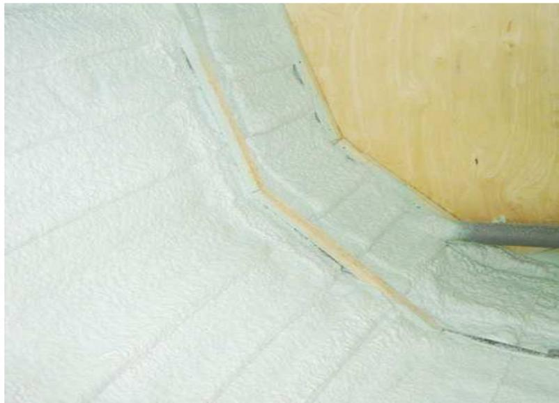
On n'isole pas sous la flottaison car l'eau est un régulateur thermique. Mais on descend environ 20 à 30 cm sous la flottaison, et contre la voûte arrière car la mousse est aussi un isolant phonique.
