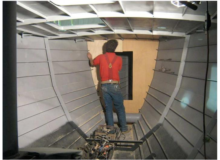
Fabrication des gabarits des futures cloisons d'Impermanence, Chatam 43 à coque acier et pont inox. Leur pose dans le bateau pas encore isolé.
