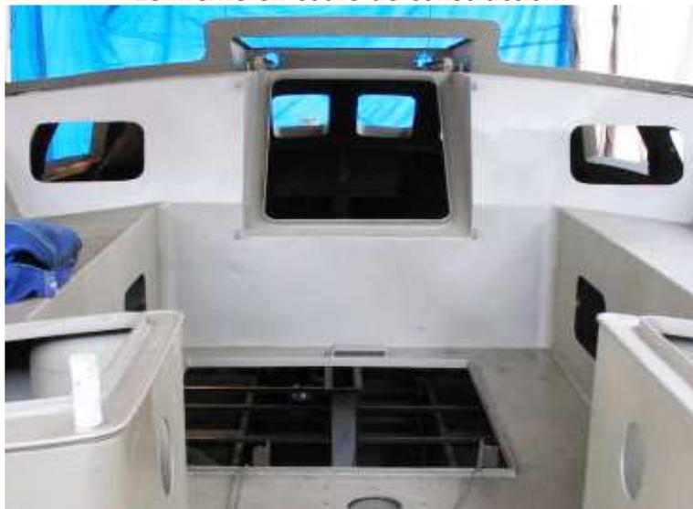
Autre Chatam 40, mais à descente centrée, et inclinée à 45°. En bas de la photo on voit la préparation pour une colonne de barre à roue. Noter l'accès au moteur en fond de cockpit : attention à son étanchéité ! Le surbau, hauteur entre le fond métal du cockpit et le bas de la découpe de descente est de 400mm minimum pour les unités de « haute mer » (A et B)
