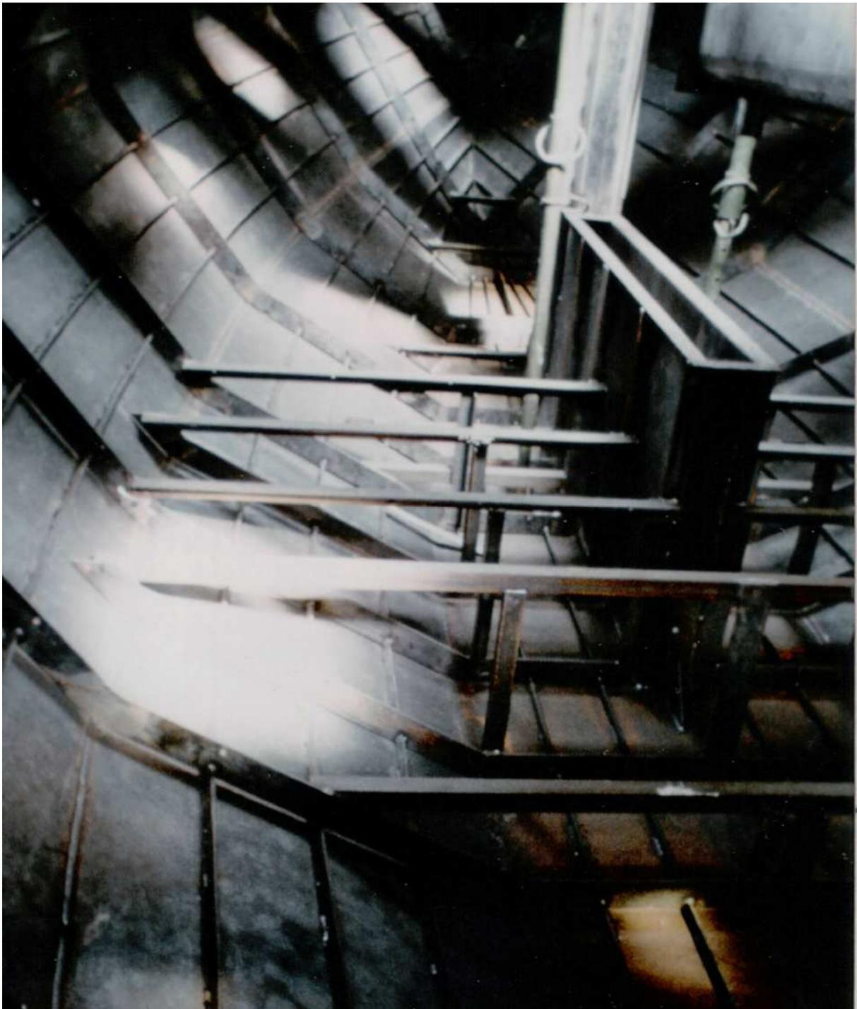
Structure « mécano-soudée » des fonds d'un dériveur intégral. La plomberie passe facilement. Il faudra rapporter les tôles périphériques de la caisse à lest.
