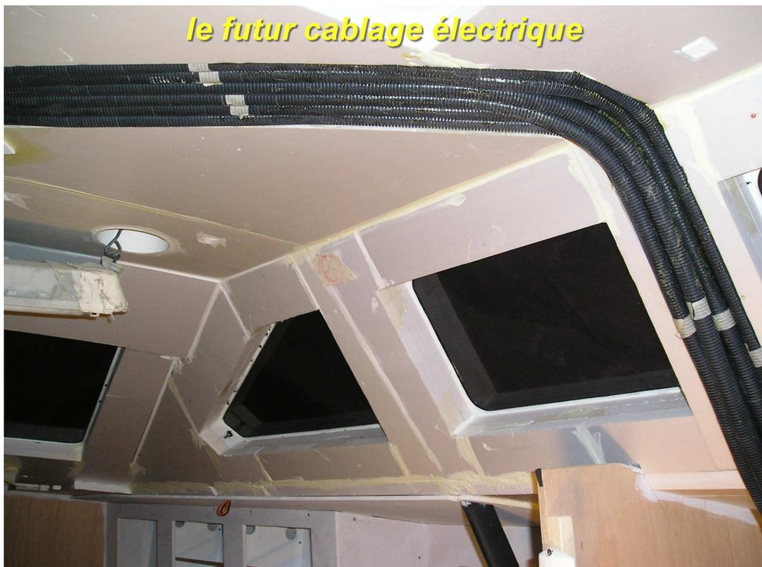
Les câbles doivent passer dans des gaines (contre les ragages) et le plus haut possible. L'ensemble des circuits internes est en 12v. On ne fait aucune mise à la masse sur la coque ou ses appendices. Tout doit être isolé, y compris le moteur : 2 pôles isolés. Une prise de quai pour du 220 est isolée et protégée.
