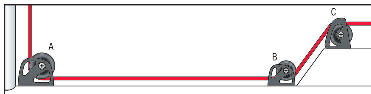
4. On doit utiliser des poulies spéciales quand il faut remonter sur un rouf ou une teugue.
