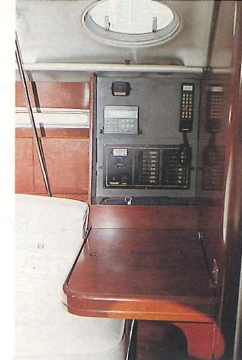
La table à cartes du First, positionnée à l'envers de la marche du bateau, est dépourvue de rangements et moins confortable pour le navigateur.
