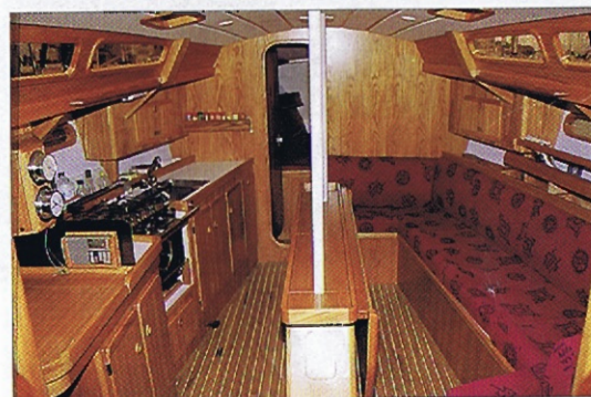
Ovni 345. Le carré disposé en dinette, avec un puits de dérive situé au milieu du carré qui supporte la table.
