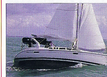
Le gréement sans patacas ni bastaques du Hunter demande un réglage sans faille pour raidir l'étai.
