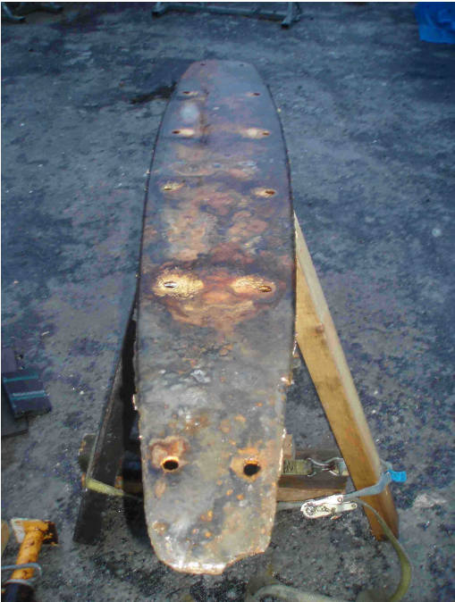
Agée de 40 ans, la quille est globalement en bon état, le chantier aura quelques trous à boucher après sablage.
