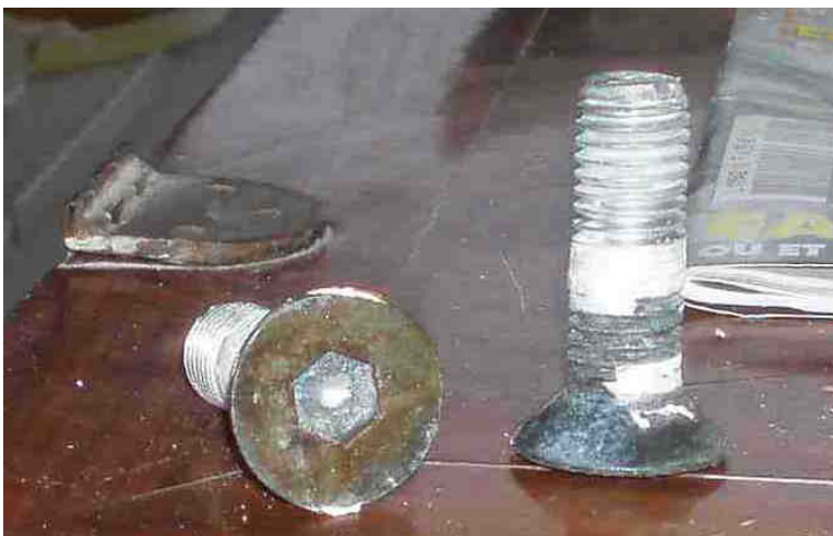
Sur les douze boulons, seuls deux étaient réellement oxydés, tous les autres étaient globalement en bon état...
