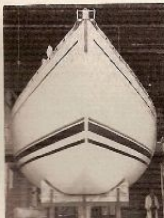
La forme du berceau met en évidence le plat sous la section avant.
