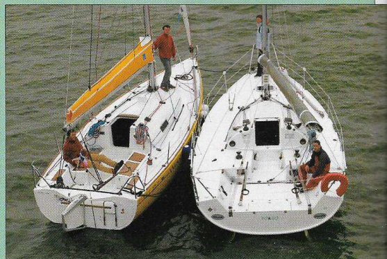
Le plan de pont du First apparaît presque classique à côté du Pogo extra large avec ses deux barres et ses deux safrans.
