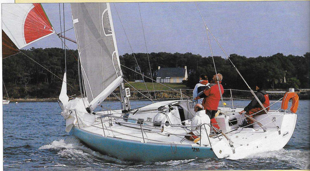
La largeur du tableau arrière du Pogo impose la présence de deux safrans contrôlés ici par deux barres franches excentrées.
