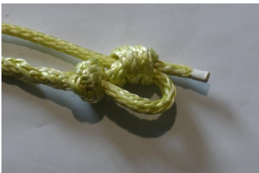
Etape 1 : Sur un brin libre, confectionner un triple capucin qui enserre le deuxième brin libre.
