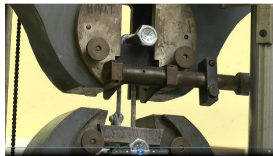
2, Le glissement n'est pas visible à l'œil nue, mais le déplacement est continue tandis que la force de traction est constante.
