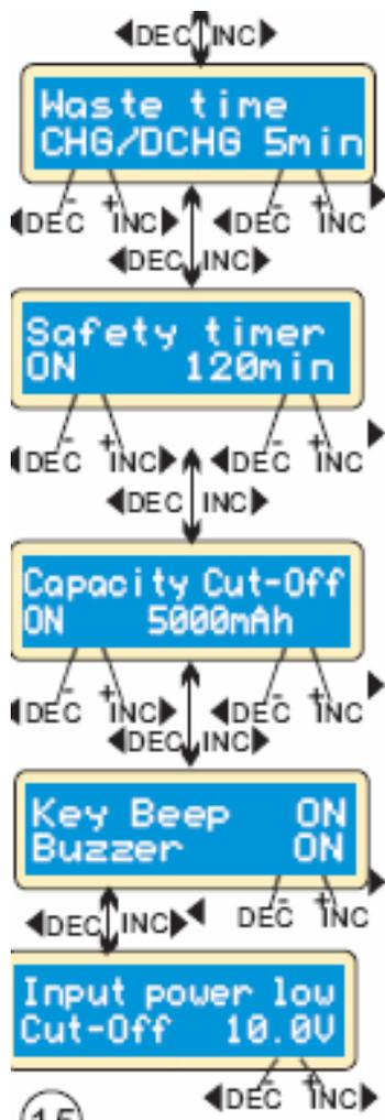
La batterie devient chaude après des cycles de charge/décharge. Le programme insérera un délai entre chaque processus de charge/décharge pour laisser à la batterie le temps de refroidir avant de débuter le nouveau cycle. La plage est réglable de 1 à 60 minutes.
