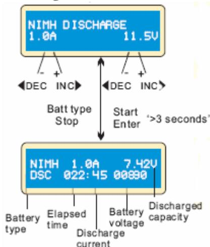
Le courant de charge est réglé sur la gauche et la tension finale à droite. La plage de courant de charge est de 0.1 à 1.0A ; la plage de tension finale est de 0.1 à 25.0V. Appuyer sur START/ENTER pendant plus de 3 secondes pour démarrer le programme.
