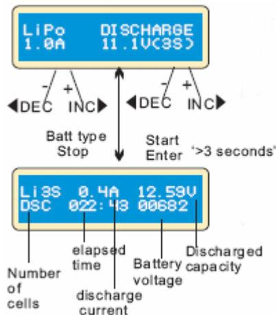
La valeur du courant de décharge à gauche ne doit pas excéder 1C, et la valeur à droite ne doit pas être inférieure à la tension recommandée par le constructeur pour éviter de trop décharger la batterie. Appuyer START/ENTER pendant plus de 3 secondes pour commencer à charger.
