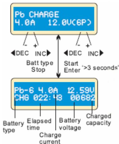
Définir le courant de charge à gauche et la tension nominale à droite. La plage de courant est 0.1-5.0A, la tension devrait correspondre à la batterie une fois chargée. Appuyez sur START/ENTER pendant plus de 3 secondes pour commencer à charger.
