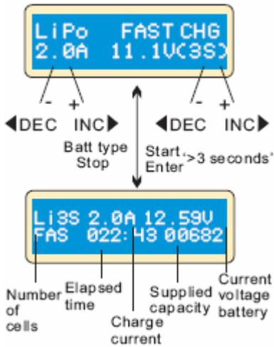
Le courant de charge va diminuer en fin de charge.
