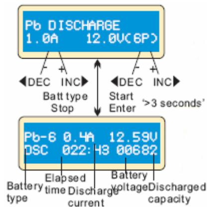
Définir le courant de décharge à gauche et la tension nominale à droite. La plage de courant est de 0.1-5.0A, la tension devrait correspondre à la la batterie une fois chargée. Appuyez sur START/ENTER pendant plus de 3 secondes pour commencer à charger.
