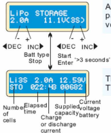
**A** Sur cet écran, vous pouvez définir le courant et la tension de la batterie. La charge et la décharge ajusteront la tension de la batterie à celle définie dans les paramètres de stockage.
