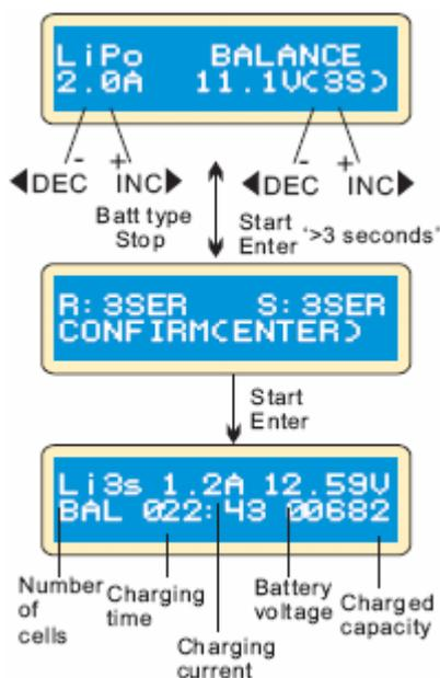
La partie gauche de la première ligne affiche le type de batterie sélectionnée. La valeur à gauche de la deuxième ligne est le courant de charge sélectionné par l'utilisateur. Après paramétrage du courant et de la tension de charge, appuyer sur la touche START/ENTER pendant plus de 3 secondes pour commencer le processus (courant de charge : 0.1-5.0A, tension : 1-5V).
