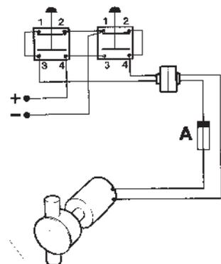
Suggestion de raccordement de la pompe à huile de cale (vidange/remplissage)
