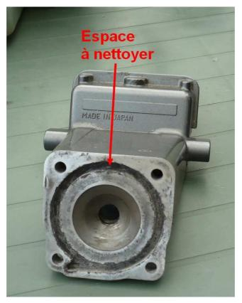
Voilà circuit de refroidissement est propre, on remonte le tout avec 2 joints neufs : le joint entre le cylindre et la culasse et le joint entre le moteur et l'embase.
