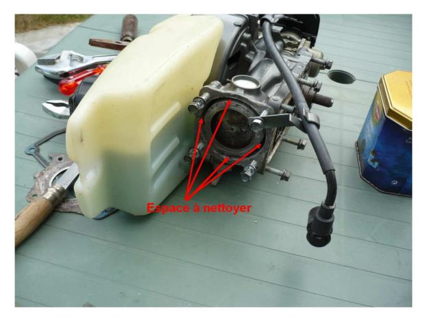
On retire le joint entre la culasse et le cylindre et on nettoie le circuit de refroidissement de la culasse.
