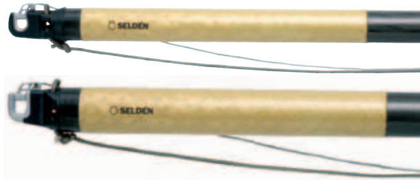
Protection en Twaron en option. Les filaments de Twaron protègent le tangon contre le ragage sur l'étai ou les haubans.
